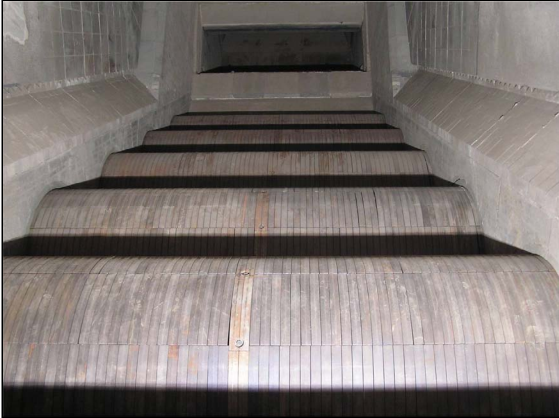
2. ábra: 30°-os lejtésű, hat hengerből álló rostélyrendszer
