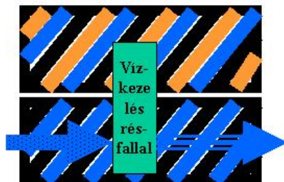
7. ábra: Szennyezett talajvíz in situ kezelése aktív résfal segítségével
